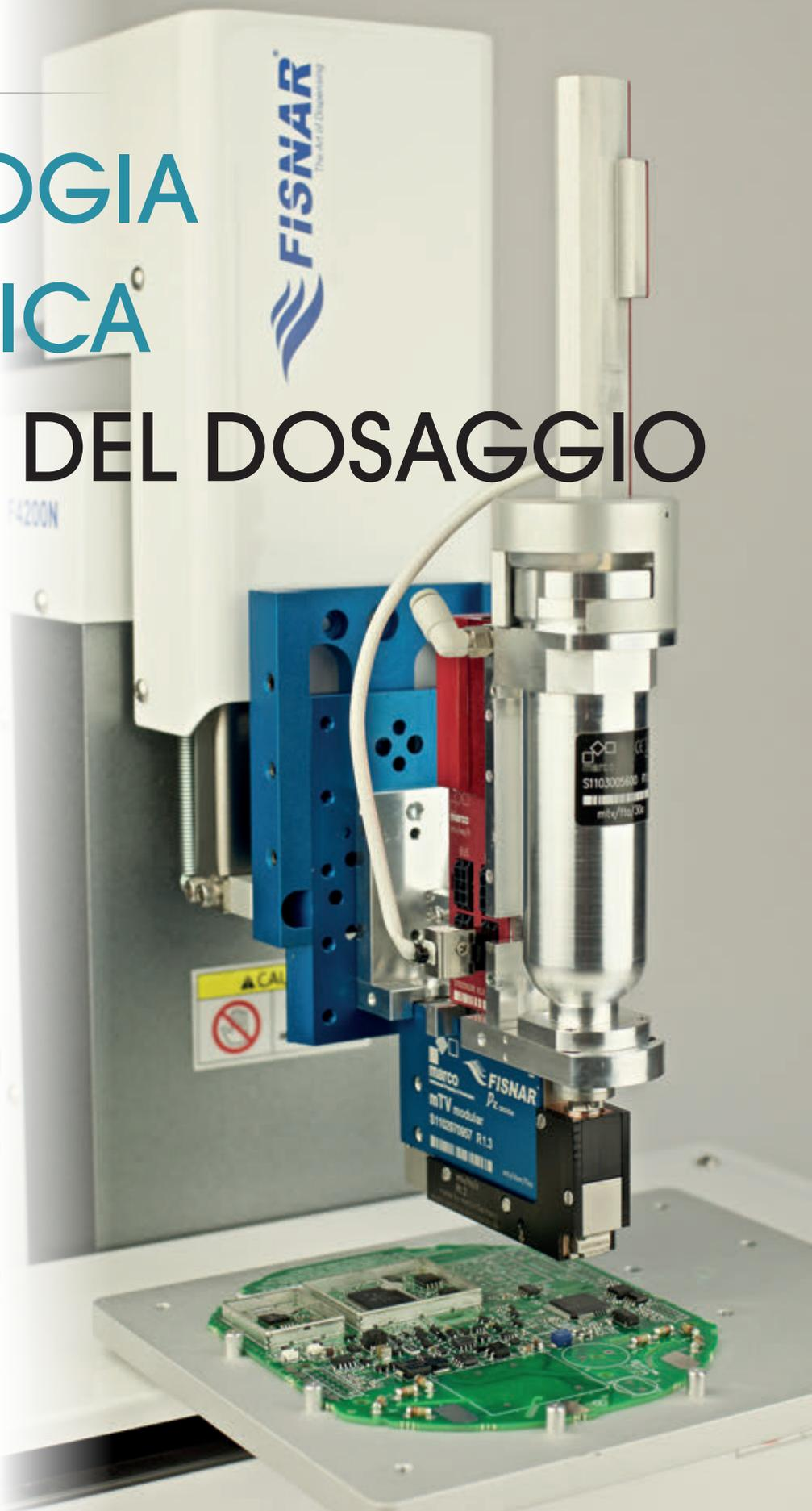
quando viene applicata della tensione. Questo processo crea una deflessione del braccio cantilever che solleva la sfera in ceramica dell'attuatore dalla sua sede, permettendo al fluido di riempire la cavità.
